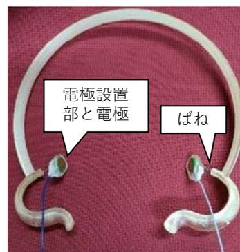
図 6 脳波測定治具V
