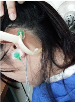
図 9 脳波測定治具(Prototype V)の装着
