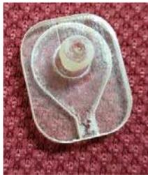
図7 脳波測定治具Vの電極設置部
