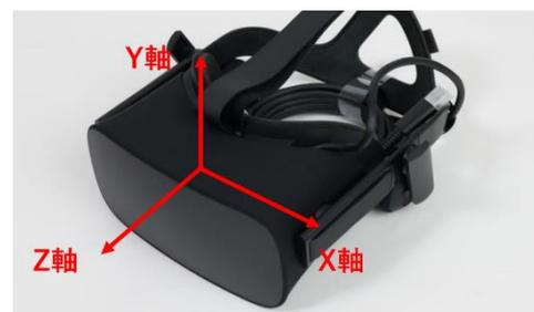
図 3 HMD の向きと 3 軸センサの方向
