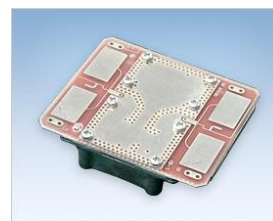
型番: NJR1478J 外形: 46.5mm×40mm×12mm 中心周波数: 10.525±0.005GHz 動作電圧: +5.0±0.2V 消費電流: 30 mA
