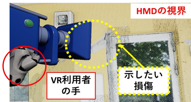
図 21 独立視点のカメラによる指示機能 (HMD 視点の視界)
