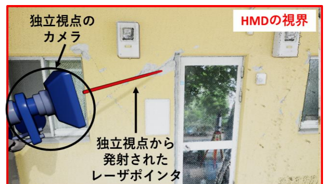
図 20 レーザーポインタによる指示機能 (HMD 視点の視界)
