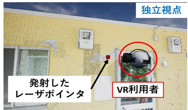
図 19 レーザーポインタによる指示機能 (周りの人の視界)
