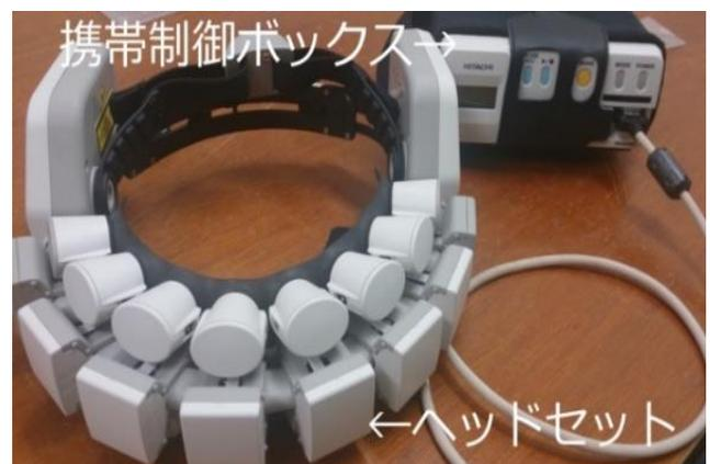
図1 ウェアラブル光トポグラフィ装置
