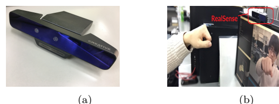
図 3 撮影環境 (a) RealSense 本体 (b) 撮影風景
