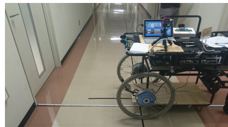
図 15 角度 75 度の時の壁と電動ストレッチャーの位置関係 Fig. 15 Stretcher and Wall when Camera angle is 75 degree
