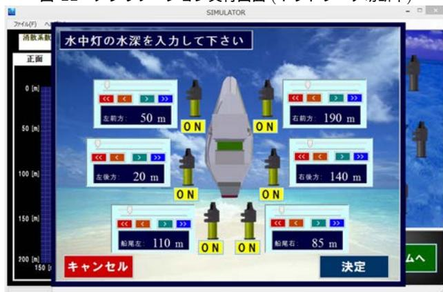
図 12 各水中灯の点灯状態及び水深入力画面
