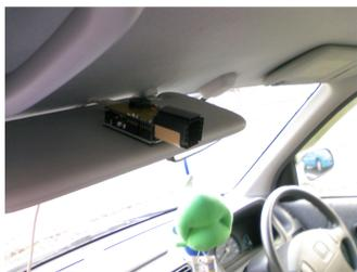
図 1 車内における赤外線センサ取り付けの様子
