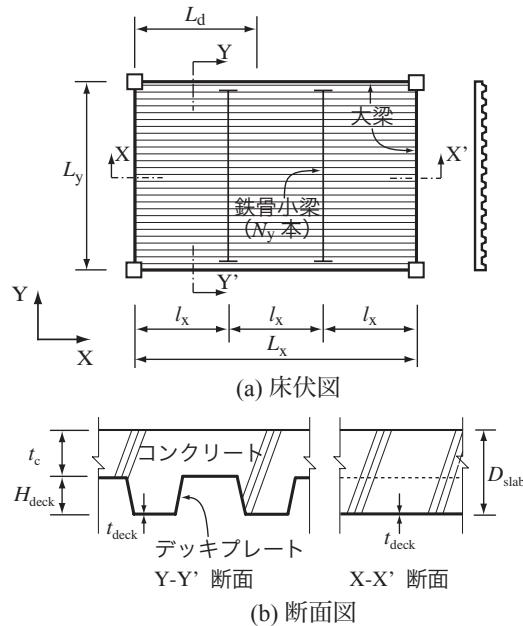
図1 デッキプレート床組の構成
